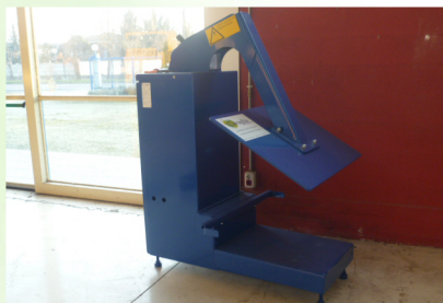
PRESSA MAC FAB TRITAVETRO E PRESSA MAC FAB BIDONI 1100 LT RIDUZIONE VOLUMI SCARTO RISPARMIO SMALTIMENTO
